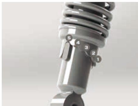
Levels Federvorspannung . 5. Mindestvorspann- 1. maximale Vorspannung.
