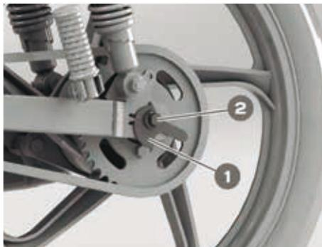
1. Antriebskettenspanner 2. Achsmutter des Hinterrades
