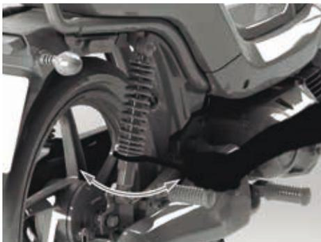
Einstellung der Federvorspannung.
