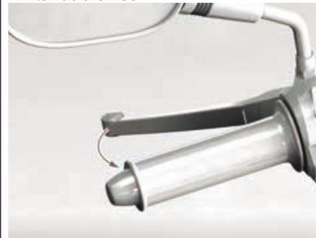
Bremshebel der Hinterradbremse.
