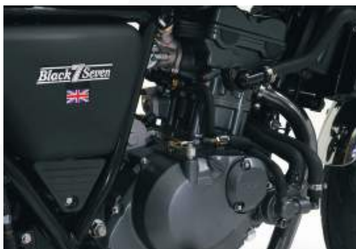
Moteur Hyosung 4T, monocylindre double arbre
